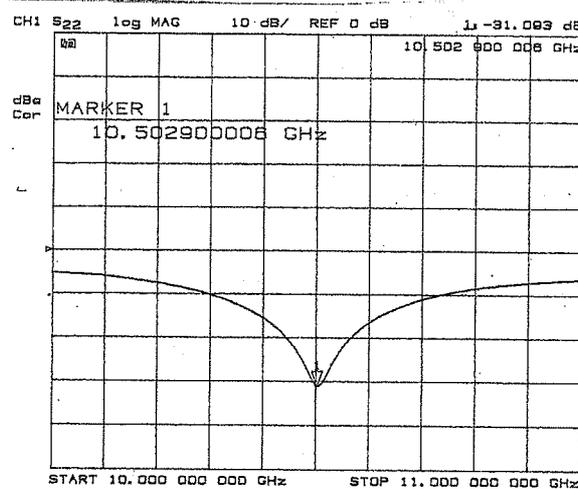
On obtient un RL de -31 dB à 10,502 GHz .
