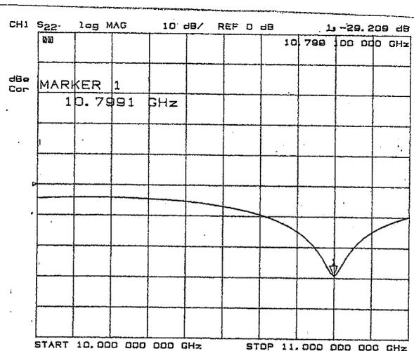
La dimension  $u$  ne joue pratiquement pas sur la fréquence à laquelle la transition est adaptée, soit 10,779 GHz pour RL=-29 dB
