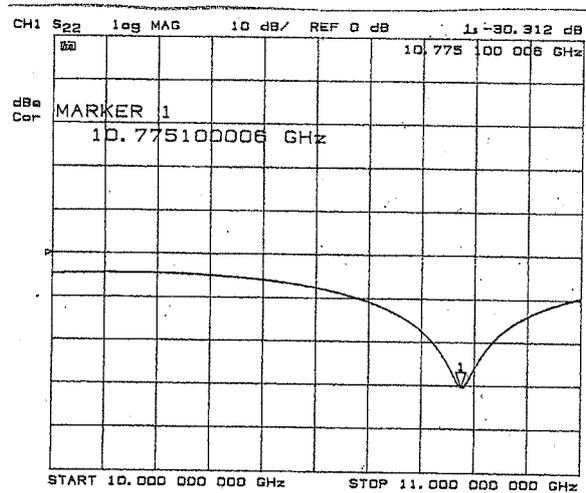
On voit que la transition est adaptée à 10,775 GHz (RL = -30 dB) et non à 10,368 GHz. Notre première réaction a été de se dire que la dimension  $u$  ( $\lambda_g/4$ ) devait être mauvaise et nous avons donc augmenté cette valeur de 0,5 mm, et nous avons obtenu :
