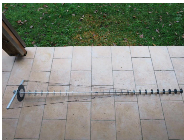
Figure 17 : Antenne disque-Yagi à 1420MHz, photo F6ETU
