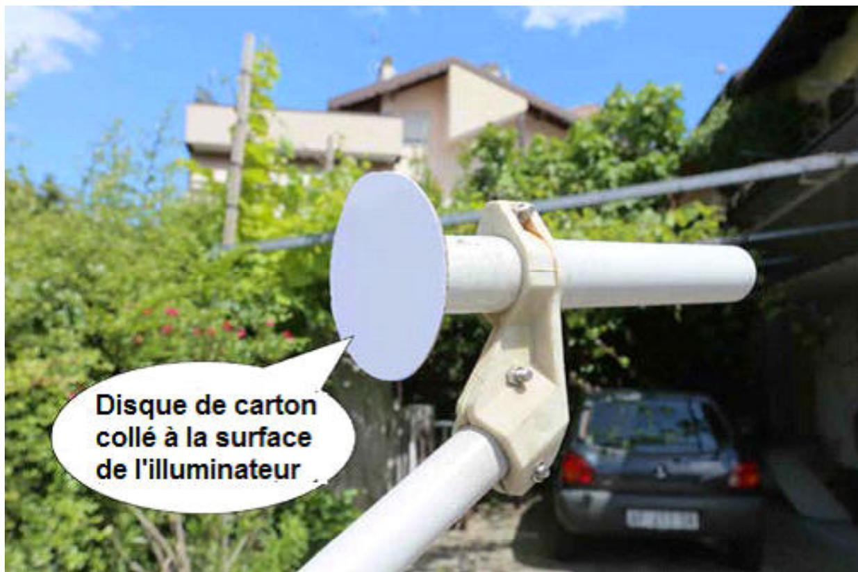
Exactement au niveau de la face avant du feed, j'ai placé un disque de carton blanc en le collant sur un tube de plastique qui simulait le feed.
