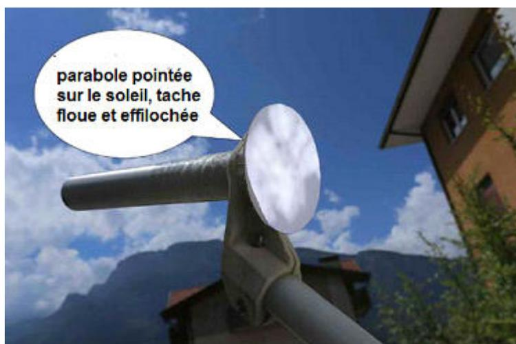
Enfin, j'ai pointé la parabole vers le soleil en m'assurant que les rayons réfléchis par les miroirs tombaient tous dans la partie centrale du disque cartonné. J'ai ensuite affiné la mise au point en déplaçant le disque en carton d'avant en arrière afin de rendre le point lumineux aussi petit, plus clair et plus intense que possible. À ce stade, je craignais que le carton ne s'enflamme, mais heureusement, j'ai vu que la chaleur produite n'était pas suffisante pour enflammer le disque de carton !
