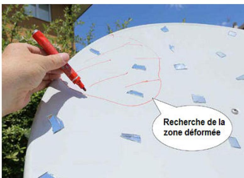
A l'oeil il était difficile de voir la déformation car quelques millimètres suffisent pour dégrader la forme parabolique.
