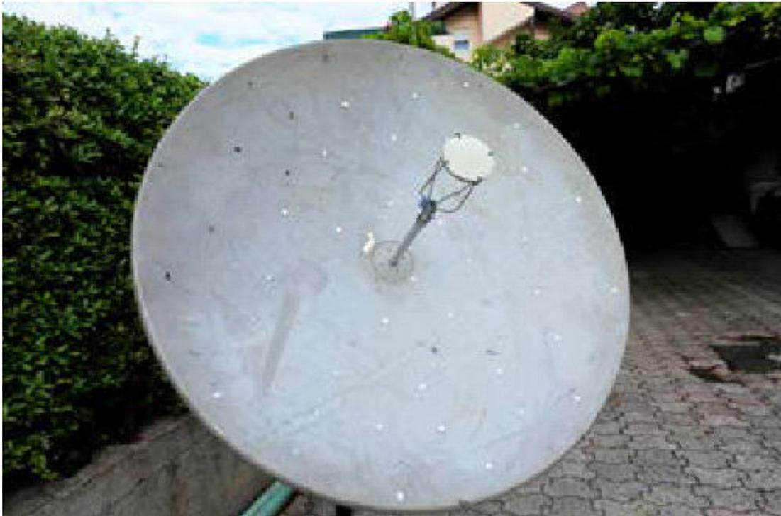
J'ai dirigé la parabole vers le soleil, en m'assurant que l'ombre du disque cible tombait au centre de la parabole. J'ai ensuite fait défiler le disque cible vers l'arrière à la recherche de la position de mise au point où les rayons réfléchis par les miroirs convergeaient de la façon la plus compacte possible.
