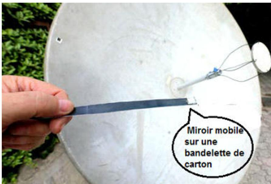
Les rayons du soleil réfléchis par les quatre miroirs sont utilisés pour trouver la meilleure position de mise au point pour la cible, tandis que le miroir mobile est utilisé pour scanner soigneusement chaque zone en le reposant sur la surface de la parabole. Lors de cette analyse, il faut faire très attention à ce que le miroir mobile reste parfaitement adhérent en appui sur la surface de la parabole.
