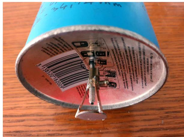
La diode au bout du semi rigide et le sub-réfecteur
