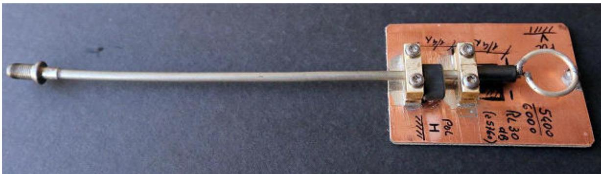
Sur les conseils de IN3OTD j'ai finalement construit une autre sonde sensible au champ magnétique. L'idée de base était de détecter les lignes de flux magnétique qui sont créées dans la partie métallique du réflecteur parabolique lorsqu'il est frappé par le signal émis par la source. Les photos suivantes montrent mon artefact, laid mais fonctionnel.
