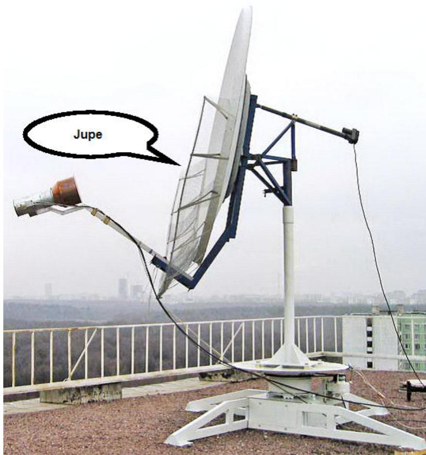
La photo ci-dessus montre l'antenne déportée de 2,4 m de RW3BP. Elle illustre comment il est possible de surmonter le problème du débordement inférieur (ou overlap), en montant une grille de blindage dans la partie inférieure de la parabole.
