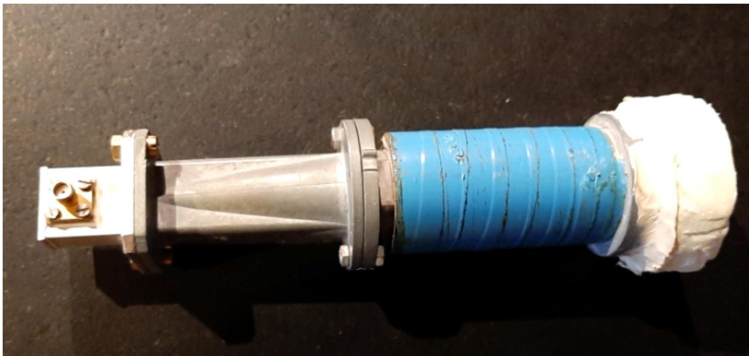
Ici un cornet Visiosat pourvu d'un radôme de protection en polystyrène extrudé, connecté sur l'adaptateur Visiosat fixé sur une transition coaxiale WR75.
