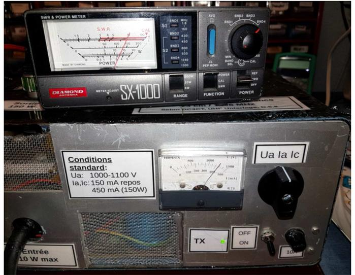
Le "driver" dans son boîtier final en test avec le PA 2C39 connecté. Tout fonctionne !
