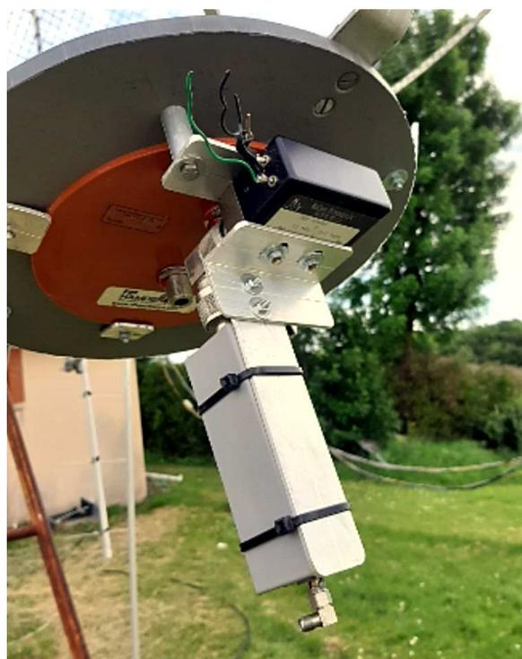
J'ai mesuré la perte des câbles coaxiaux TX RX entre le transverter et la source (le transverter est sur le pylône), avec du RG214 cela fait quand même 2 dB de perte ! Je remplacerai par du câble italien plus tard, quand je monterai le 13 cm sur la source, sans doute cet automne. Mais il pleut souvent alors je travaille sur le 47 GHz ci-dessous.
