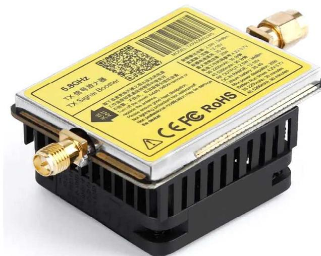
Modifications : ôter l'atténuateur d'entrée et remplacer les SMA d'origine (une était une SMA inverse et l'autre mal montée).
