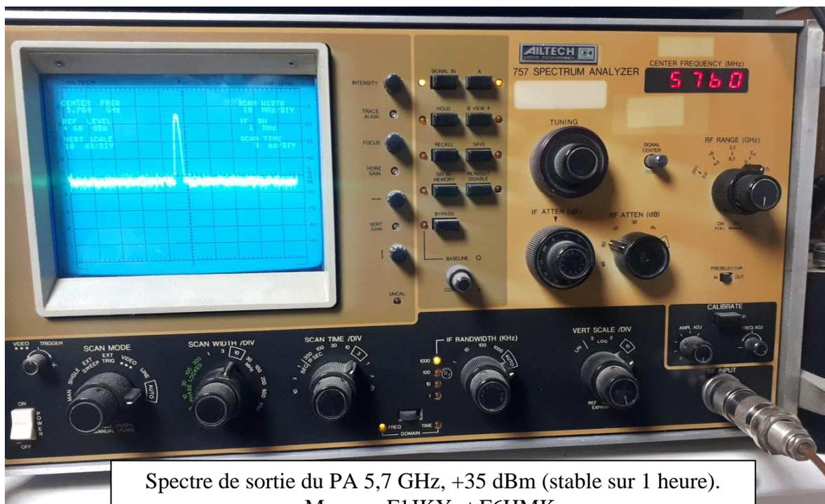
Testé en Tx pendant 1h, puissance de sortie stable et pas d'harmoniques constatés.
