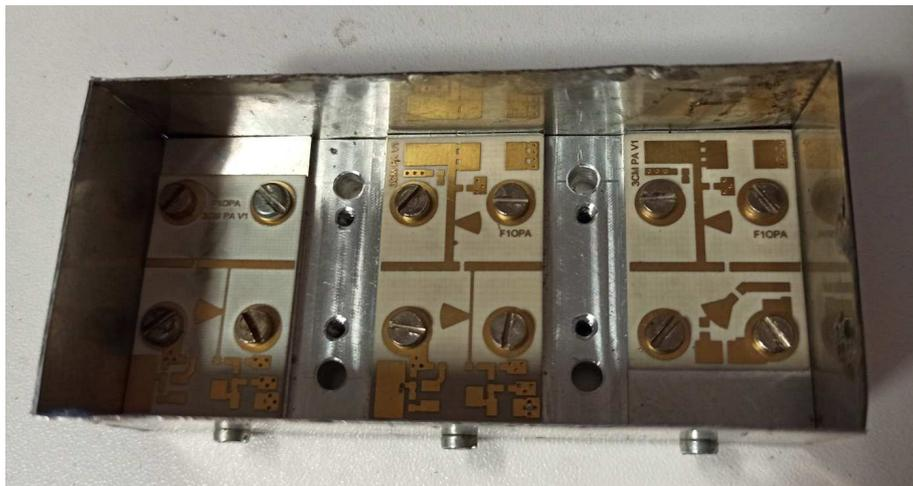
L'assemblage mécanique avant câblage
