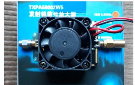
Ci-après l'ampli modifications effectuées, SMA changée et atténuateur en entrée remplacé par une résistance de zéro ohm en 0603 ou 0402.
