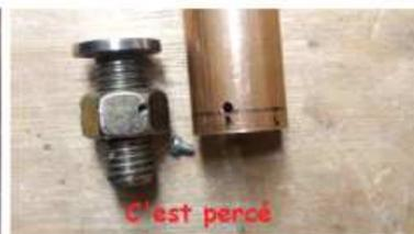
2 vis de 2.5 mm pour fixer l'écrou et le 3° qui permet le blocage définitif.
