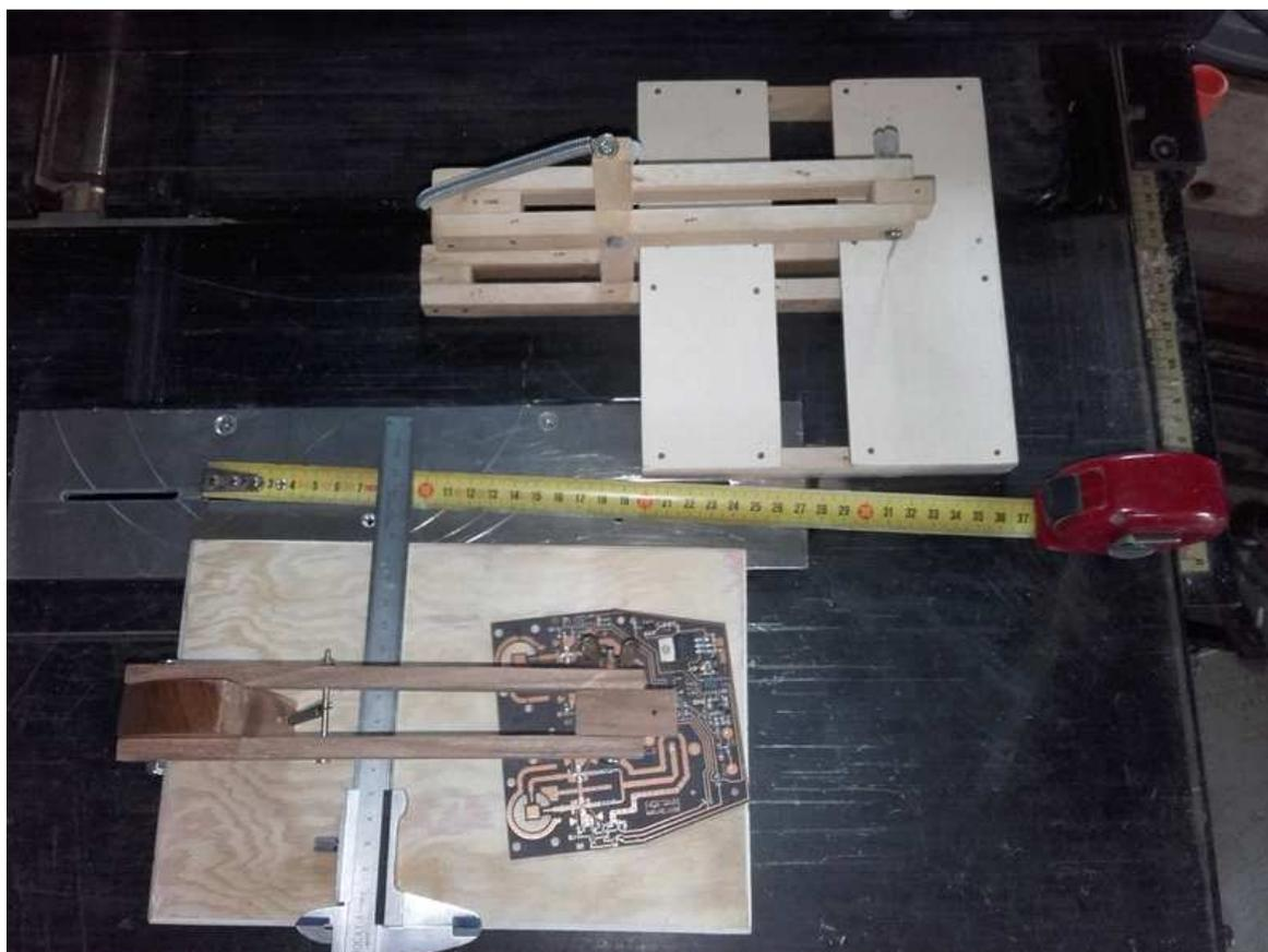
Avantage ? les deux mains sont libres pour la soudure, l'orientation peut être corrigée facilement avec la pince brucelles ou en effectuant une légère rotation du circuit. Les composants sont plaqués et ne risquent pas de bouger ni présenter une patte plus haute ou décalée.
