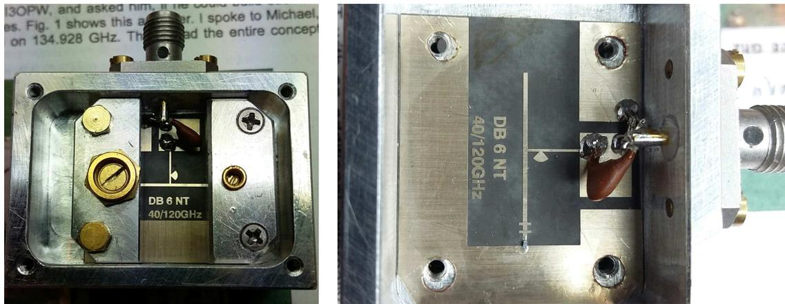
Tête 122 GHz en boîtier DL2AM avec et sans les éléments de réglage
