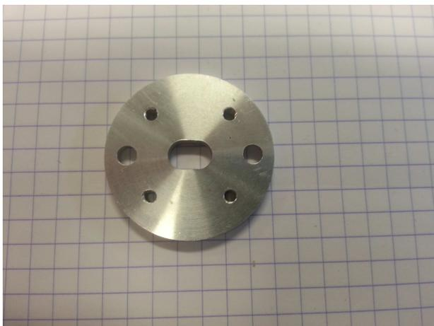
L'épaisseur de la cale est de 3,45 mm. La lumière est réalisée avec une fraise de 6 mm entre deux perçages de 6 mm espacés de 1,6 mm par rapport à l'axe central. Quatre trous taraudés permettent de fixer la bride du WR42 ; les deux trous extrêmes permettent de fixer la cale sur la bride du WR42 avec des vis à tête fraisée (les trous sont donc aussi fraisés en dessous).
