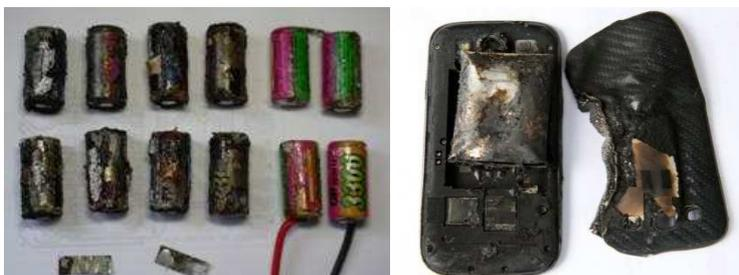
Figure 3. Accumulateurs détériorés
