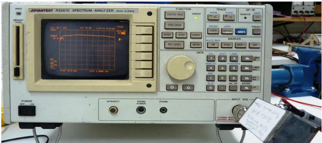
Ci-dessus la courbe de la réponse en fréquence obtenue avec le circuit monté sur FR4. L'amplificateur qui suit la source de bruit possédant un gain élevé, il faut donc éviter à tout prix les oscillations parasites ; pour cela, **deux mesures obligatoires** :
