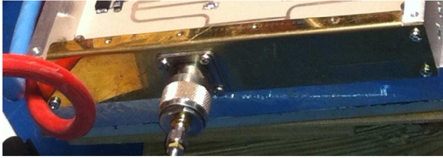
Figure 9 : Flasque d'entrée en tôle de laiton
