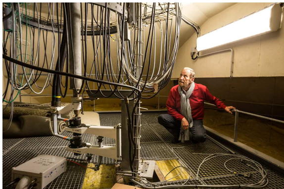
Dans le plénum, juste en dessous de PB8. A gauche le transverter 5,7 GHz.
