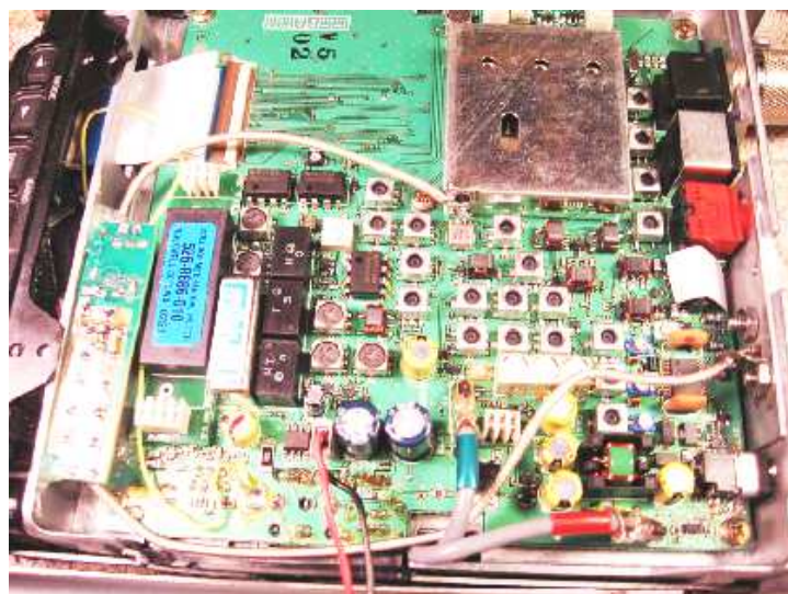
Figure 15 – installation par N1JEZ dans un FT-817 avec filtre CW
