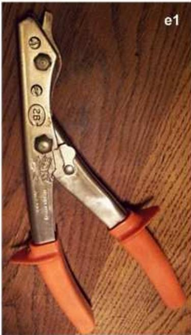
Pour les découpes rectangulaires ou arrondies, j'utilise une cisaille grignoteuse (e1) pour tôle de 1,5 et alu de 2 mm d'épaisseur max (environ 15€/20€), pensez à prendre des couteaux de rechange... (e2)
