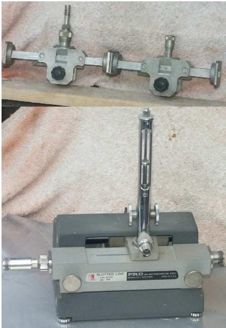
Lignes en guide Philips 10 gigas, celle à gauche pour mesures, celle à droite pour réglages stubs.
