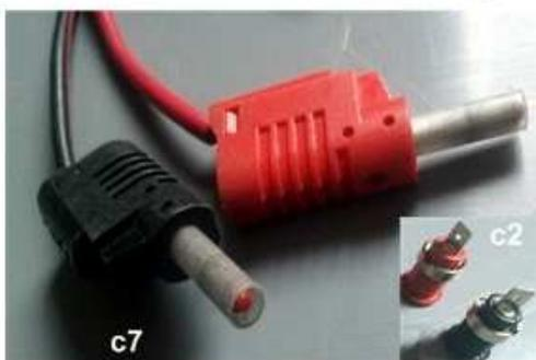
Nous avons vu dans le dernier chapitre les douilles et fiches bananes (**c7/c2 page 4**) de diamètre 4 mm pour les entrées/sorties d'alimentation DC .
