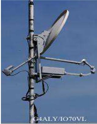
J'ai récemment réalisé une série de mesures solaires afin d'évaluer la différence en performance entre une parabole offset et une parabole prime focus de même diamètre. Bien entendu les comparaisons ne concernent que l'antenne et son illuminateur, le système de réception est identique dans les deux cas, et il est connecté directement aux antennes.
