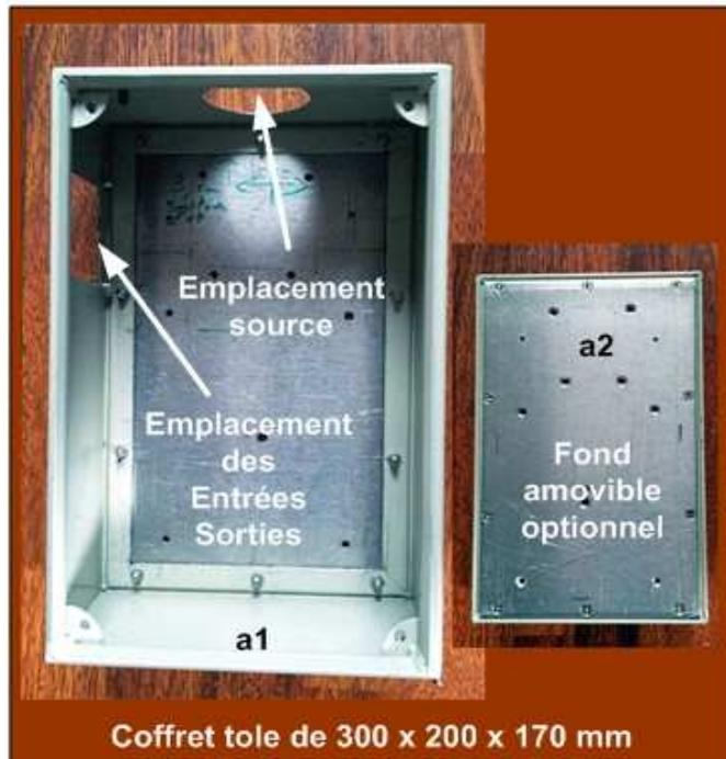
Mes 5 transverters, que ce soit en 1296 & 2320 MHz ou en 5.7, 10 & 24 GHz., ils sont construits tous selon le même principe dans un boîtier de dimension identique afin d'utiliser le même support illuminant la parabole en portable. Pour le 23 & 13 cm ils sont exploitables aussi bien en portable qu'en fixe via vos antennes ou cornets adéquats...
