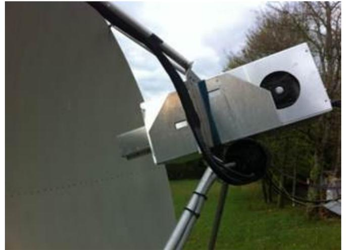
L'ensemble transverter + PA + source au sol et au foyer de la parabole.
