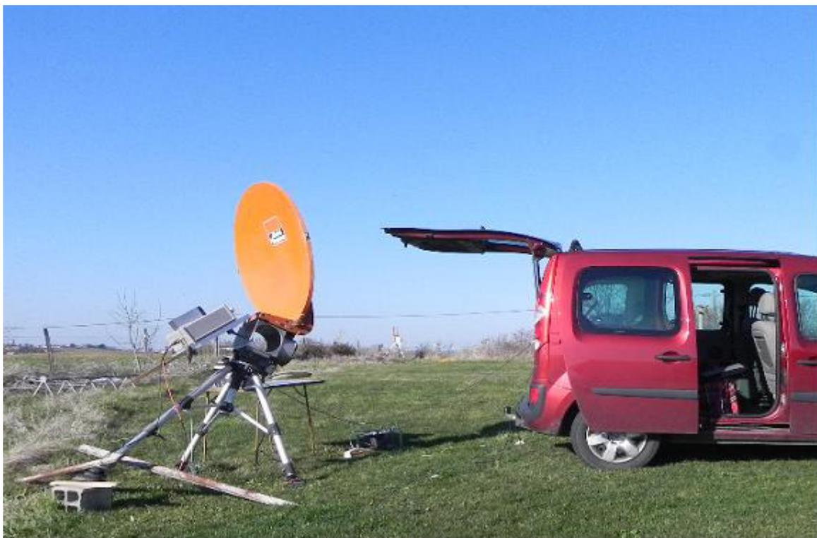
La configuration de mesure : parabole orange 1 m , transverter home made sur un plateau devant l'antenne. En rentrant les pieds arrière au maximum, en sortant le pied avant, en le surélevant un peu, une élévation maximale de 35 degrés est possible . ( Pensez quand même à un contre poids pour éviter la chute de tout le bazar en pleine mesure).
