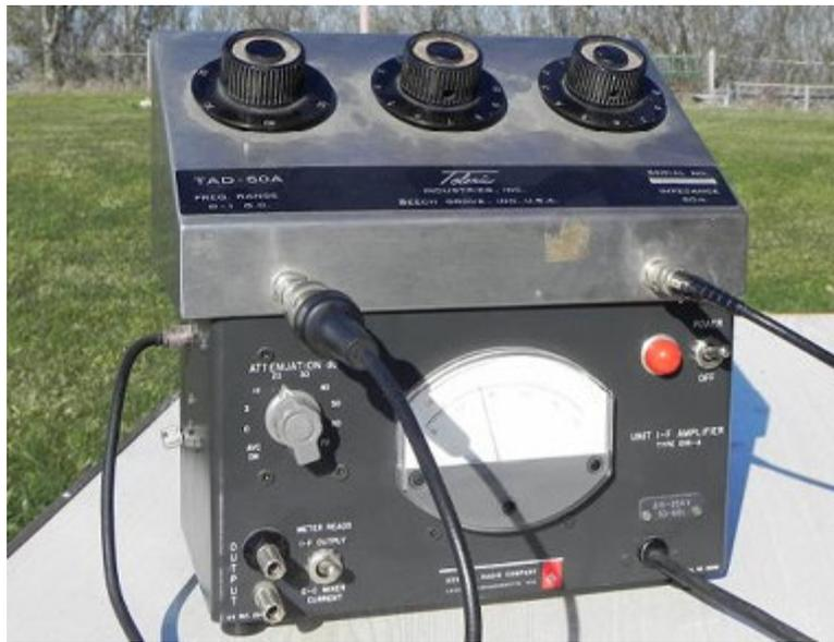
La mesure est réalisée avec deux systèmes indépendants : Ici un ampli FI General Radio, affichant en dB et ultra linéaire. Un atténuateur par pas de 0,1 dB est inséré dans la FI 28 MHz, il permet de s'affranchir des éventuelles non linéarités en réalisant une mesure à puissance de sortie constante. L'autre système utilise un SDR-IQ en mode continuum, le must pour faire ce type de mesures. Les deux systèmes donnent les mêmes résultats.
