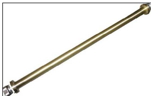
Filtres passe-bas 144Mhz QRO en 7/16 «
