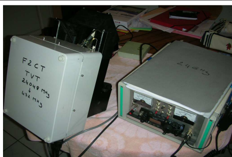
Le TVT 24 GHz dans sa configuration étanche sur support + cornet Alcatel, à droite le bloc télécommande avec le FT817 + module filtres W4RT
