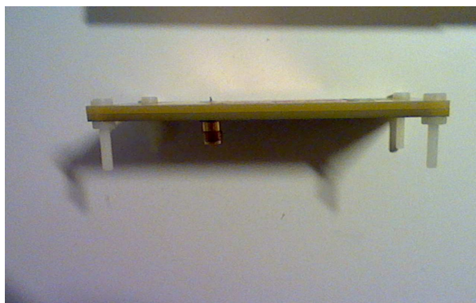
Vue de profil. On distingue le sandwich des 2 plaques de PCB
