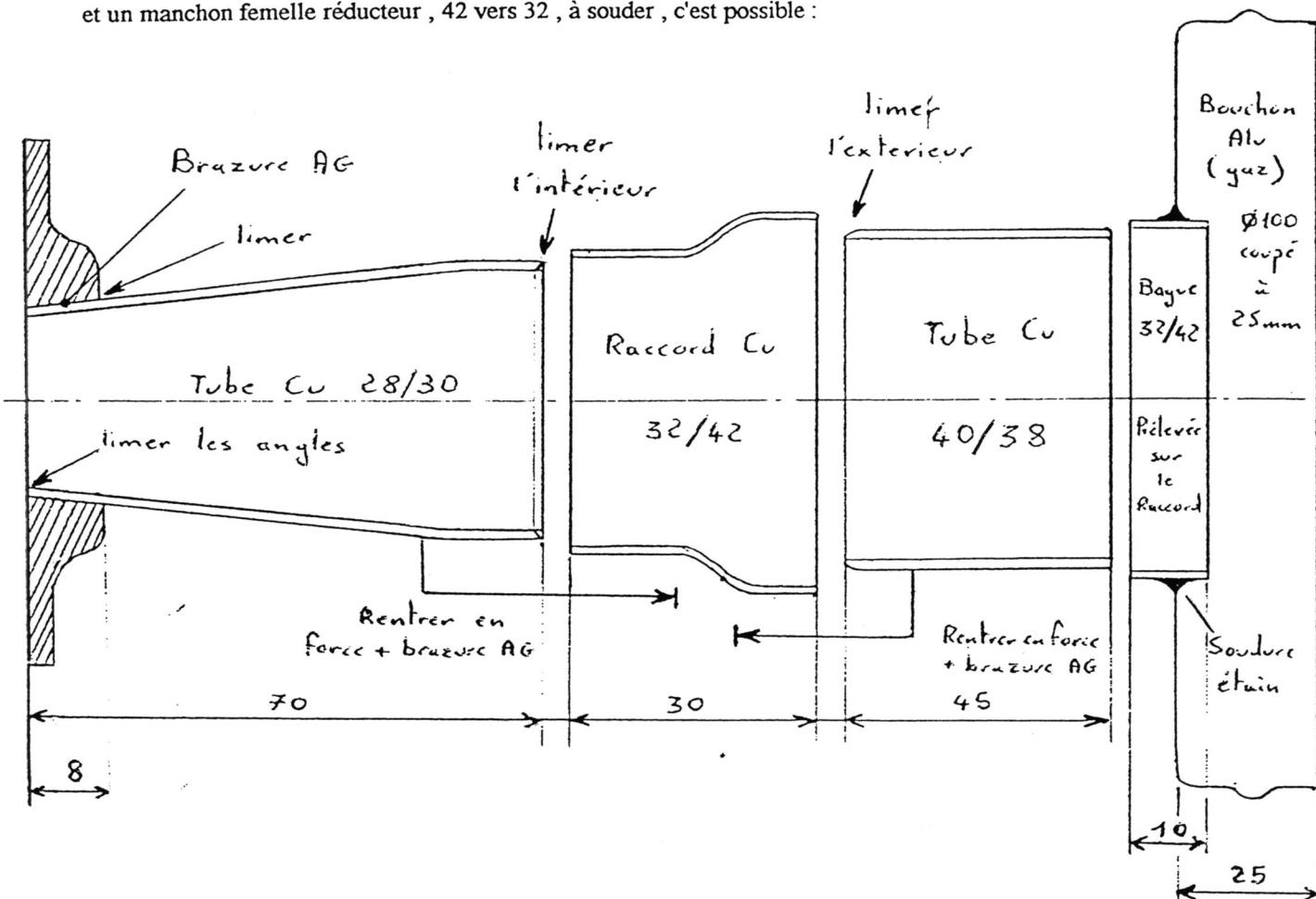
N'arrivant pas à former du tube cuivre 40 / 38 pour réaliser une illumination genre VE4MA / WB5LUA, j'ai utilisé du tube 28 / 30 qui se prête plus facilement à l'exercice ! Après avoir dévalisé le "Casto." du coin, j'ai donc trouvé un raccord à souder de 32 / 42 permettant de revenir au tube 38 / 40 ou 40 / 38 ( suivant le modèle ).
